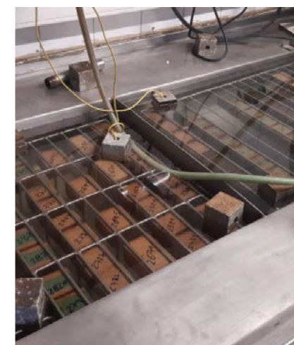
Foto's uit de praktijk: absorptietests voor diktezwellling, absorptie- en oppervlakte absorptie.
